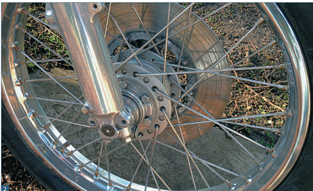
1 Een goed voorbeeld van een voorwiel met dubbele schijfrem. 2 Een spaakwiel met een enkele schijfrem.
